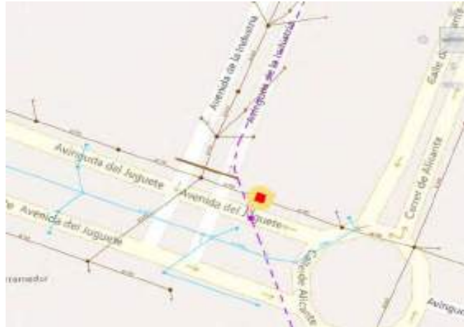
Imagen 30 Conexión a encauzamiento en Avd. del Juguete. Fuente: Ayuntamiento de Ibi
